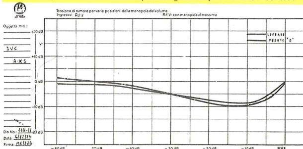
11a - Tensione di rumore in uscita per varie posizioni della manopola del volume riferita alla tensione di rumore con manopola al massimo. Ingresso Aux.
